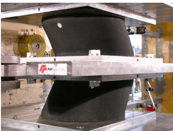
FIG. 12. Prova di determinazione del modulo statico di taglio G su una coppia di isolatori di diametro 650 mm.
